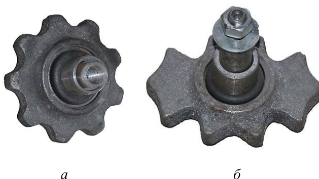
Рис. 4. Сменные звездочки КСТ-1,4: а – круглая; б – эллиптическая
