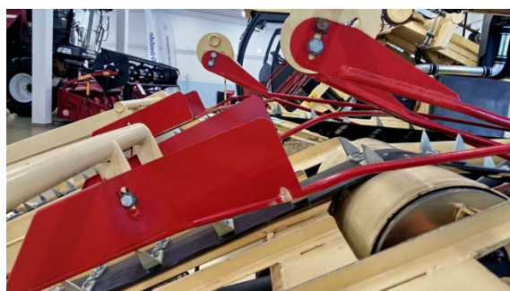
Рис. 16. Регулировочные отверстия направляющих прутков
