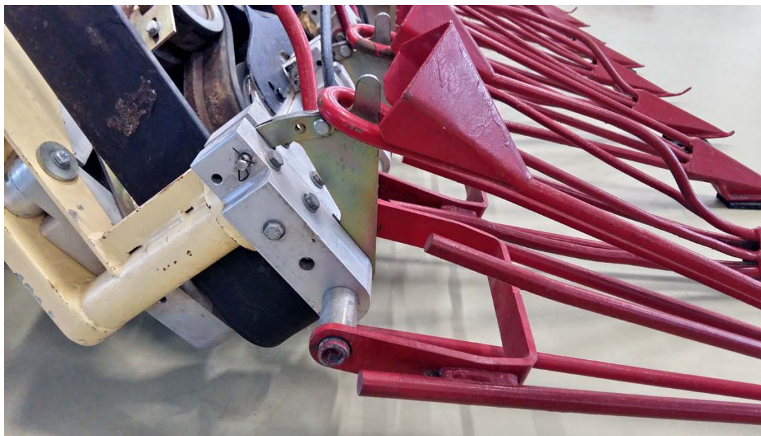
Рис. 4. Ограничитель опускания делителя с регулировочными отверстиями
