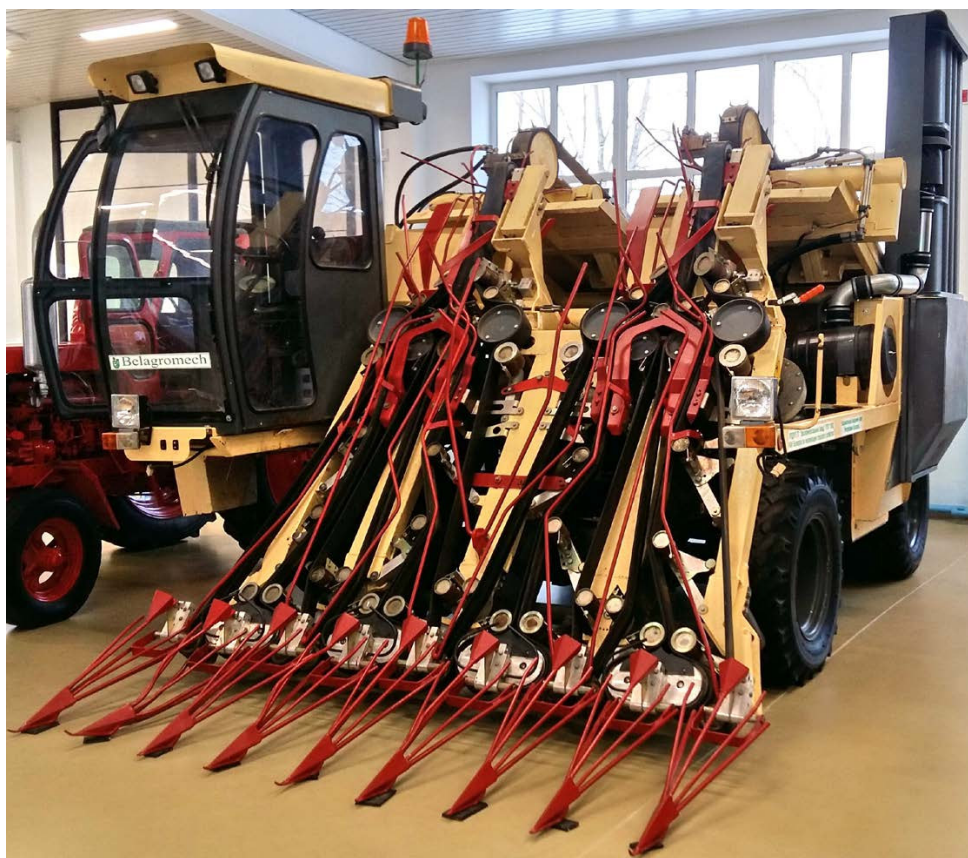
Рис. 2. Льнотеребилка самоходная двухпоточная ЛТС-2,4
