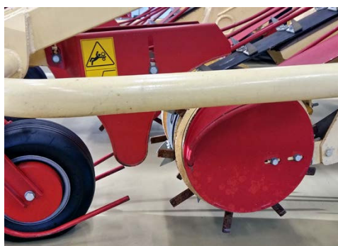
Рис. 15. Взаимное расположение направляющей рампы и подбирающего барабана
