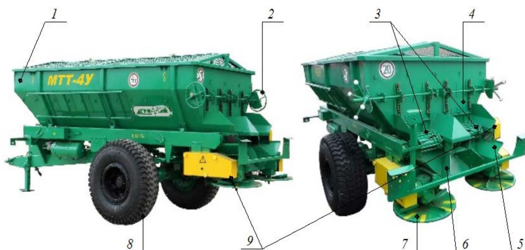
Рис. 11. Общий вид рассеивателя МТТ-4У: 1 – кузов; 2 – механизм регулировки дозирующих заслонок; 3 – подающий конвейер (транспортер); 4 – дозирующая заслонка; 5 – лоток-туюконаправитель; 6 – туюкоделитель; 7 – разбрасывающий механизм; 8 – ходовое устройство; 9 – трансмиссия
