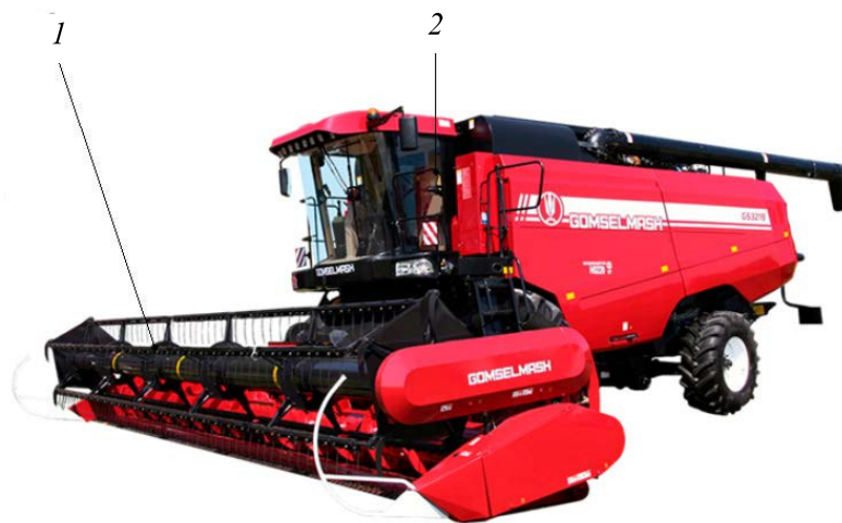
Рис. 1. Зерноуборочный комбайн GOMSELMASH GS3219: 1 – жатвенная часть; 2 – молотилка самоходная
