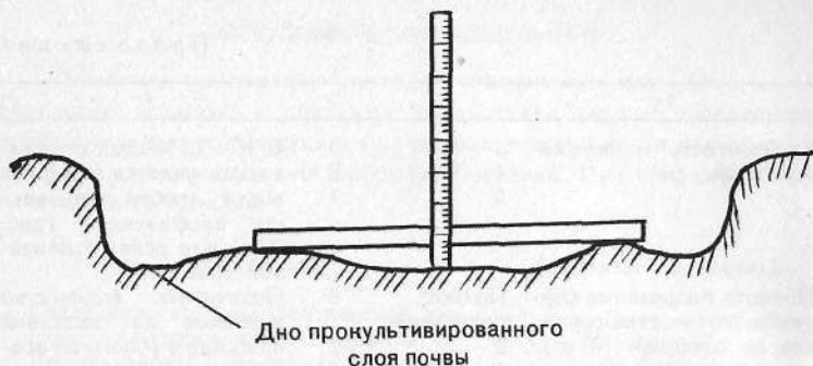
Рис. 10. Проверка выровненности дна обработанного культиватором слоя при помощи рейки с линейкой
