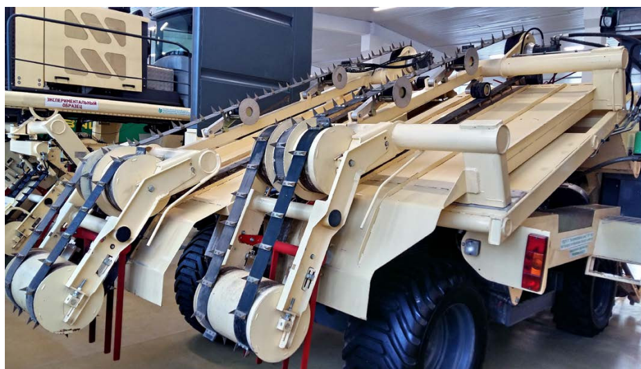
Рис. 2.3. Расстилочный стол льнотеребилки ЛТС-2,4
