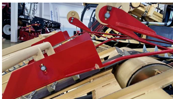
Рис. 3.7. Регулировочные отверстия направляющих прутков
