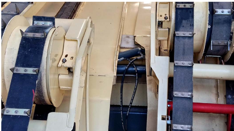
Рис. 2.8. Гидроцилиндр для перемещения транспортеров расстилочного стола
