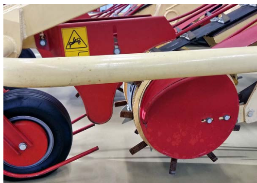
Рис. 3.6. Взаимное расположение направляющей ramпы и подбирающего барабана
