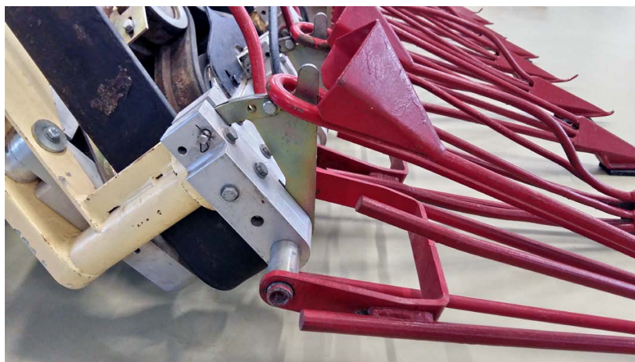
Рис. 2.4. Ограничитель опускания делителя с регулировочными отверстиями
