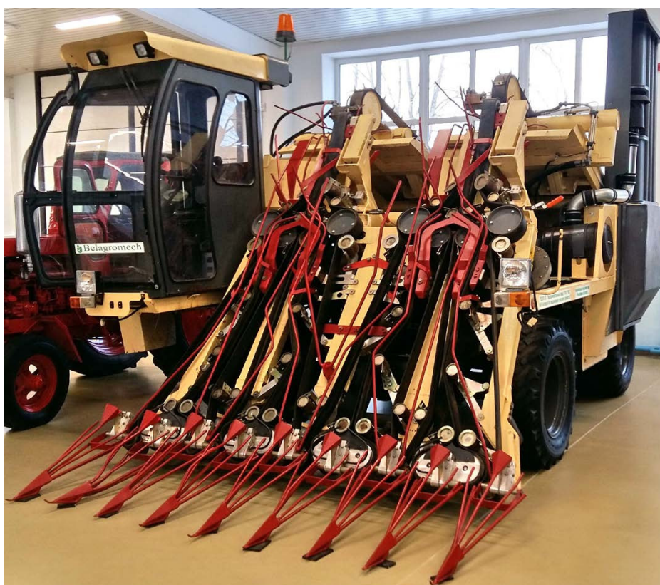
Рис. 2.2. Льнотеребилка самоходная двухпоточная ЛТС-2,4
