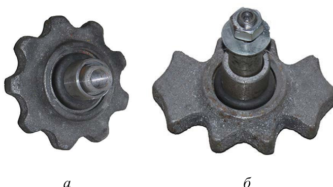
Рис. 4. Сменные звездочки КСТ-1,4: а – круглая; б – эллиптическая
