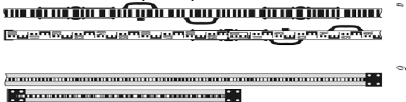
Рис. 17 Рейки для цифрового нивелира DiNi: а – LD 23/24 – деревянные складные рейки с BAR-кодом, Е градуировка, 3 и 4 м; б – LD 11/12/13 – инварные рейки с BAR-кодом, 1, 2 и 3 м
