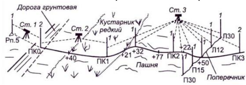
Рис.11.8. Схема начала трассы и нивелирования пикетных точек
