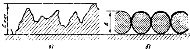
Рис. 4.5. Естественная (а) и эквивалентная зернистая (б) шероховатости.
