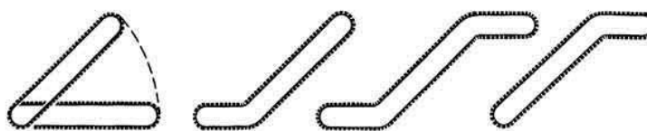
Рис. 3.32. Схемы трасс Z-образных конвейеров
