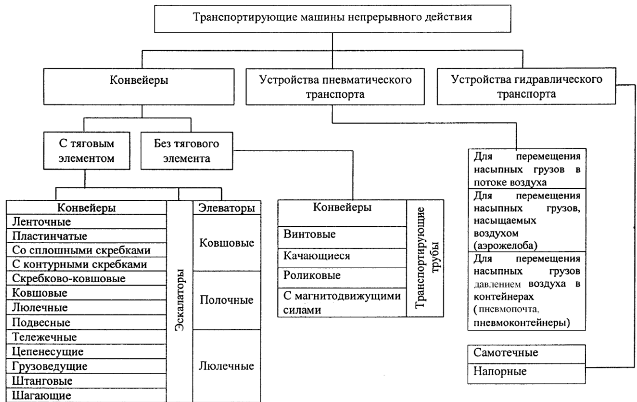
Рис. 1.1. Классификация транспортирующих машин непрерывного действия
