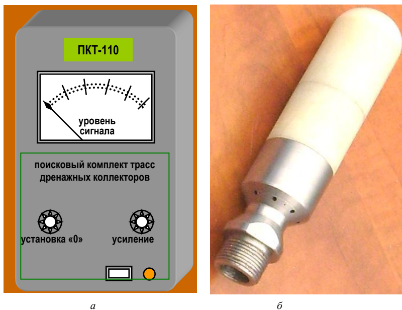
Рис. 10. Состав поискового комплекта трасс дренажных коллекторов ПКТ-110: а – приемное устройство; б – реактивная головка с генератором сигнала
