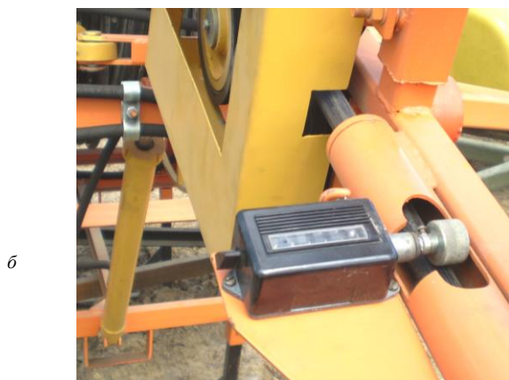
Рис. 7. Агрегаты УПД-120: а – насосная установка и блок управления рабочим оборудованием; б – счетчик длины шланга
