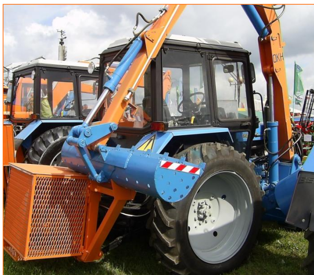
Рис. 5. Каналоочиститель многоцелевой ОКН с рабочим органом в транспортном положении
