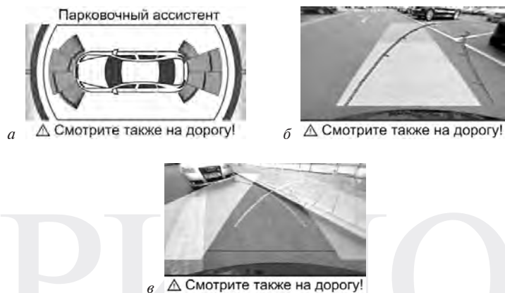
Рис. 14.13. Система парковки с камерой заднего вида:
