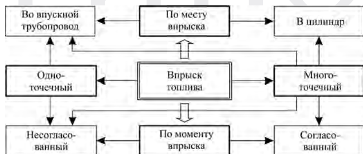
Рис. 9.1. Классификация способов впрыска топлива
