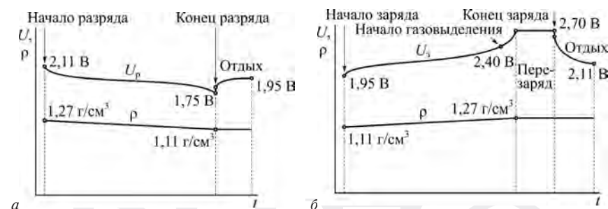
Рис. 6.3. Характеристики аккумулятора: а — разряд; б — заряд
