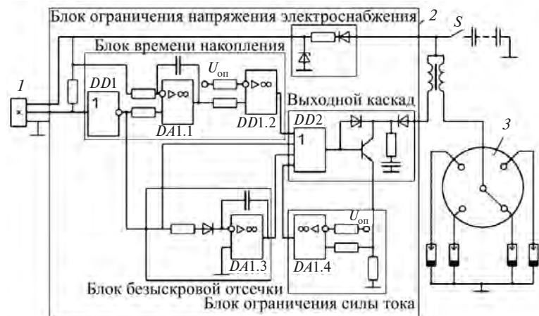
Рис. 8.7. Бесконтактная система зажигания:
