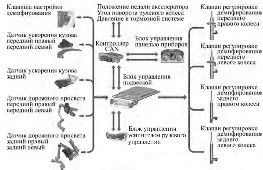
Рис. 13.14. Схема управления подвеской
