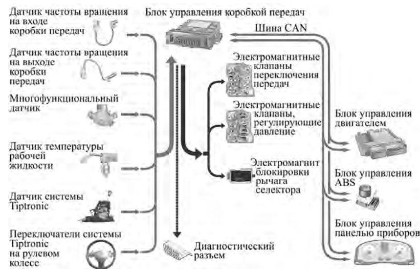
Рис. 13.6. Схема управления автоматической коробкой переключения передач
