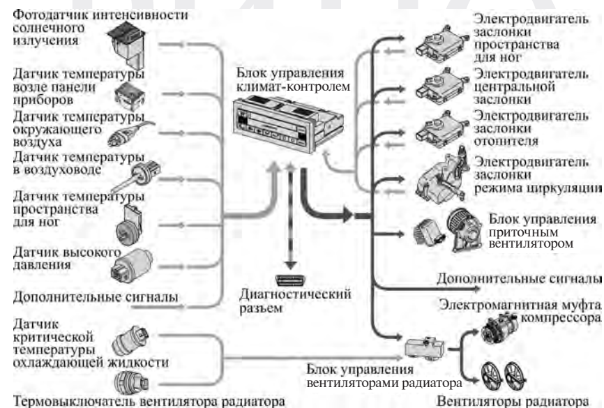
Рис. 14.2. Электронная система климат-контроля
