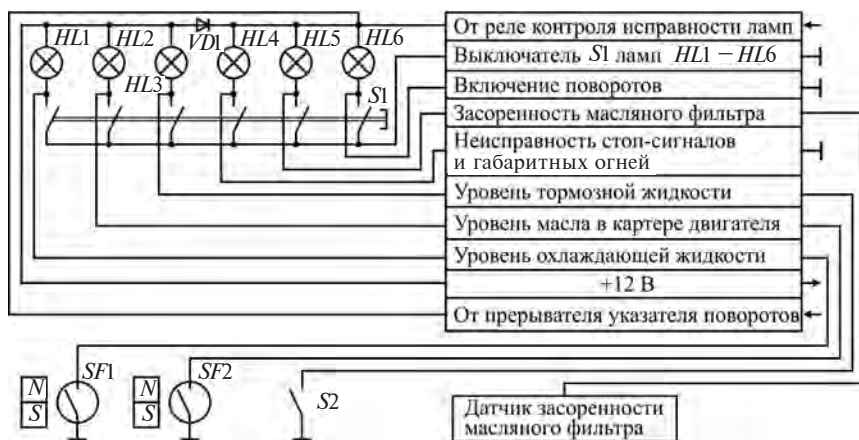
Рис. 12.23. Схема блока управления и контроля
