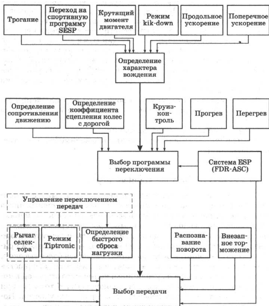
Рис. 1.10. Типовой алгоритм переключения автоматической коробки передач
