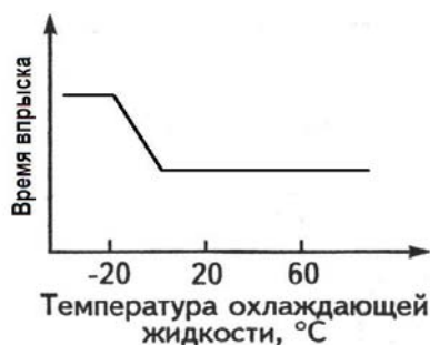
Рис. 5.22. Зависимость времени впрыска топлива от температуры охлаждающей жидкости при пуске двигателя
