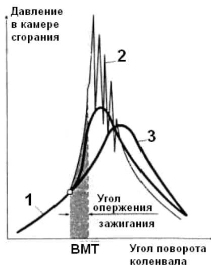
Рис. 4.15. Характер изменения давления в цилиндре двигателя: 1 – нарастание давления при нормальном процессе сгорания; 2 – нарастание давления при детонационном процессе сгорания; 3 – нарастание давления при позднем угле опережения зажигания
