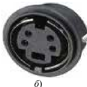
Рис. 35. Контактная конфигурация «S»-видеоразъема со стороны пайки штекера (а) и внешний вид (б):
