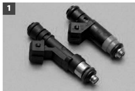
1 Новые топливные форсунки. Короткая - для 16-клапанного двигателя
