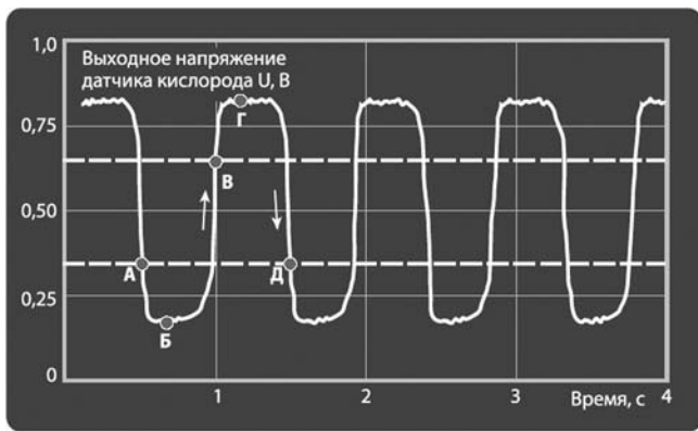
Рис. 1. Так выглядит сигнал датчика кислорода при \lambda -регулировании
