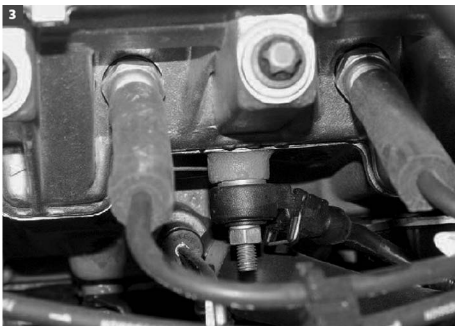
3 Датчик детонации - на старом рабочем месте
