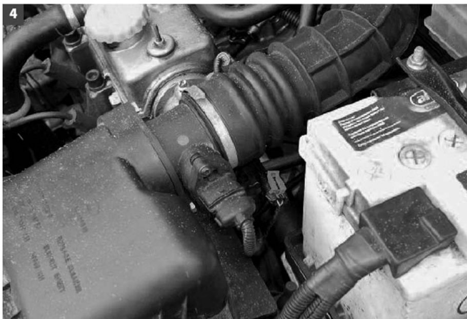
Клапан продувки адсорбера - возле воздушного фильтра (адсорбер «Калины» - около топливного бака)
