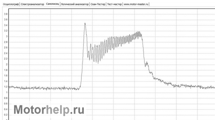
Рис. 4.8. Осциллограмма изношенного ДМРВ при резком открытии дроссельной заслонки
