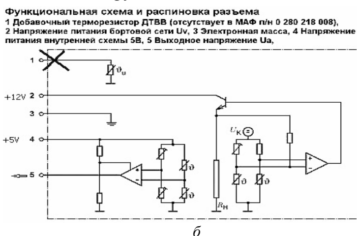
Рис. 4.5. Характеристика датчика массового расхода воздуха (выходное напряжение) в функции протекающего через него частичного расхода воздуха (а) и функциональная схема ДМРВ BOSCH HFM5 с распиновкой разъема (б)
