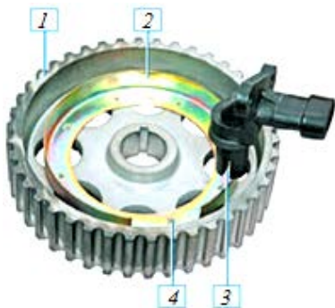
Рис. 1.4. Взаимное расположение датчика фаз и задающего диска (для наглядности показано на снятых шкиве и датчике): 1 – зубчатый шкив распределительного вала впускных клапанов; 2 – задающий диск датчика; 3 – паз в наконечнике датчика; 4 – прорезь в ободке диска
