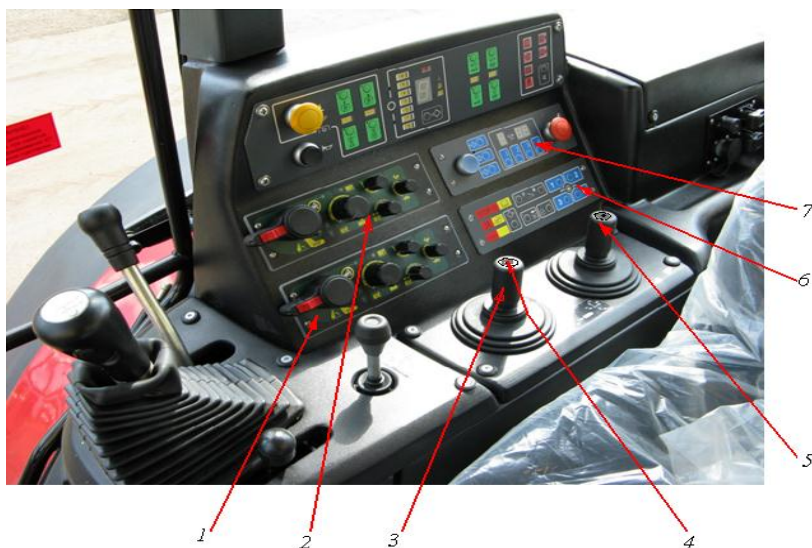
Рис. 1.1. Боковая панель управления с блоком электронных джойстиков БЭД-01: 1 – панель управления передней навеской трактора; 2 – панель управления задним навесным устройством трактора; 3 – джойстик управления 1-й и 2-й секциями распределителя; 4 – кнопка фиксирования потока масла; 5 – джойстик управления 3-й и 4-й секциями распределителя; 6 – панель электронная комбинированная (ПЭК) системы управления двигателем и внешними потребителями ГНС; 7 – блок программирования последовательности операций (БПО) управления секциями ЕНС
