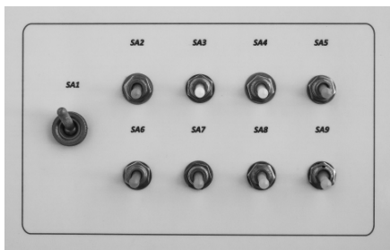
Рис. 3.3. Блок ввода неисправностей электронной системы управления секциями распределителей EHS
