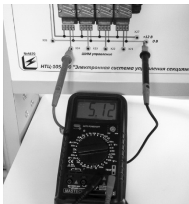
Рис. 3.5. Измерение напряжения: а – мультиметром; б – осциллографом
