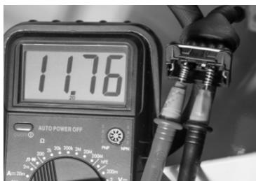
Рис. 3.4. Проверка напряжения на разъеме секции EHS
