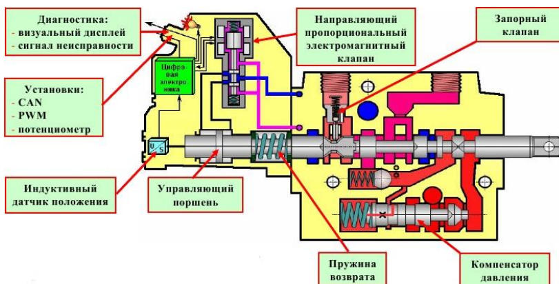
Рис. 5. Устройство распределительной секции EHS
