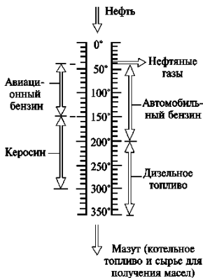
Рис. 1.3. Принципиальные схемы получения важнейших видов топлива для двигателей при перегонке нефти.
