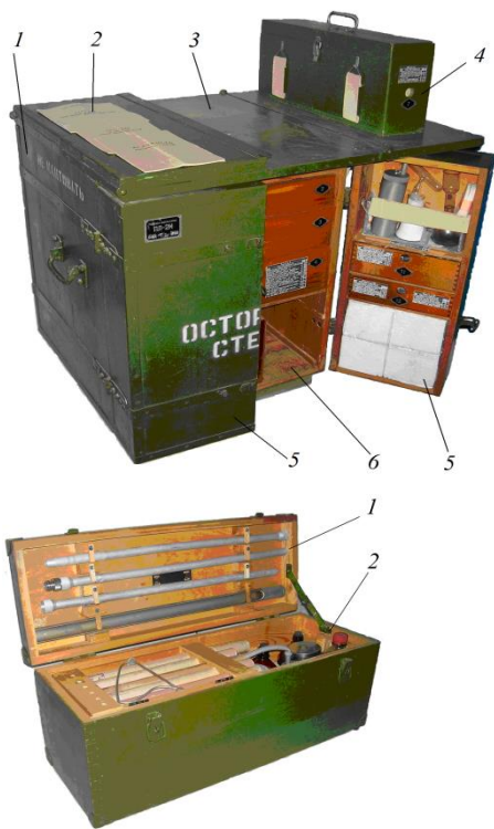
Рис. 2.2: Полевая ПЛ-2М и ручная РЛ лаборатории: а – общий вид полевой лаборатории ПЛ-2М: 1 – корпус; 2 – документация; 3 – стол; 4 – лот-пробоотборник (комплект); 5 – дверцы; 6 – ниша для лота-пробоотборника; б – общий вид ручной лаборатории РЛ: 1 – крышка; 2 – корпус.
