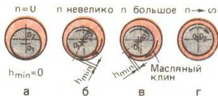
Рис. 62. Образование масляного клина при вращении вала в подшипнике скольжения.
