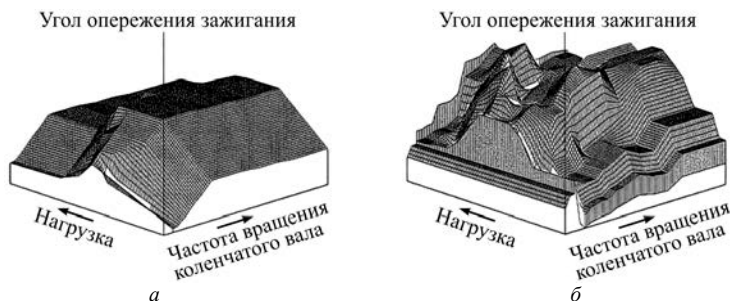
Рис. 10. Зависимость угла опережения зажигания от нагрузки и частоты вращения коленчатого вала двигателя: а – механическая система с центробежным и вакуумным регуляторами; б – электронно-оптимизированная система
