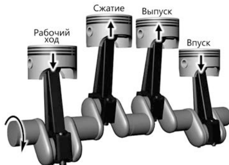
Рис. 7. Порядок работы четырехцилиндрового двигателя
