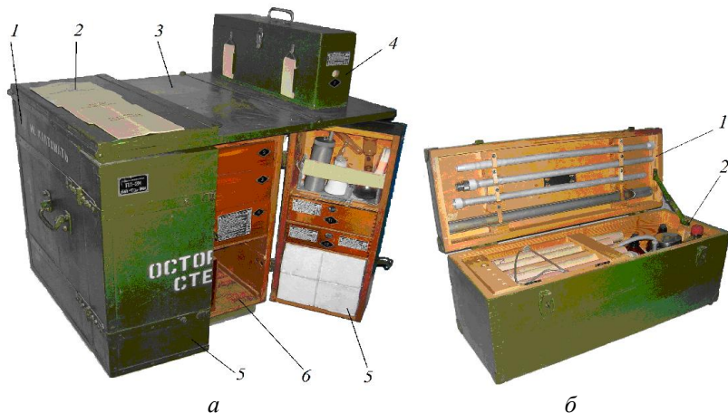
Рис. 4.1: Полевая ПЛ-2М и ручная РЛ лаборатории: а – общий вид полевой лаборатории ПЛ-2М: 1 – корпус; 2 – документация; 3 – стол; 4 – лот-пробоотборник (комплект); 5 – дверцы; 6 – ниша для лота-пробоотборника; б – общий вид ручной лаборатории РЛ: 1 – крышка; 2 – корпус.
