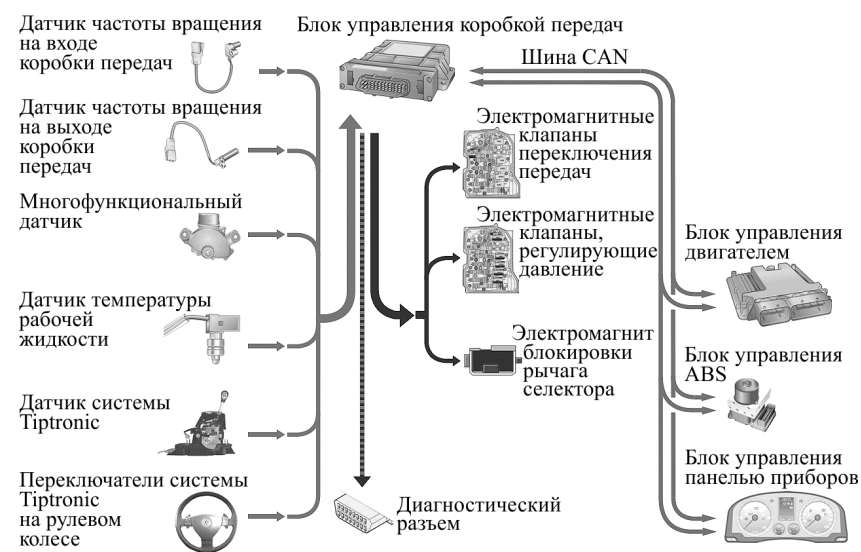
Рис. 13.6. Схема управления автоматической коробкой переключения передач
