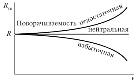
Рис. 2.46. Зависимость радиуса поворота от скорости при различной поворачиваемости автомобиля
