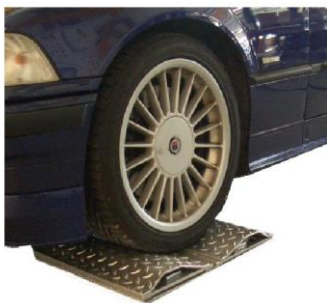
Рис. 8.6. Изображение рабочих пластин стенда AST 2.0.
