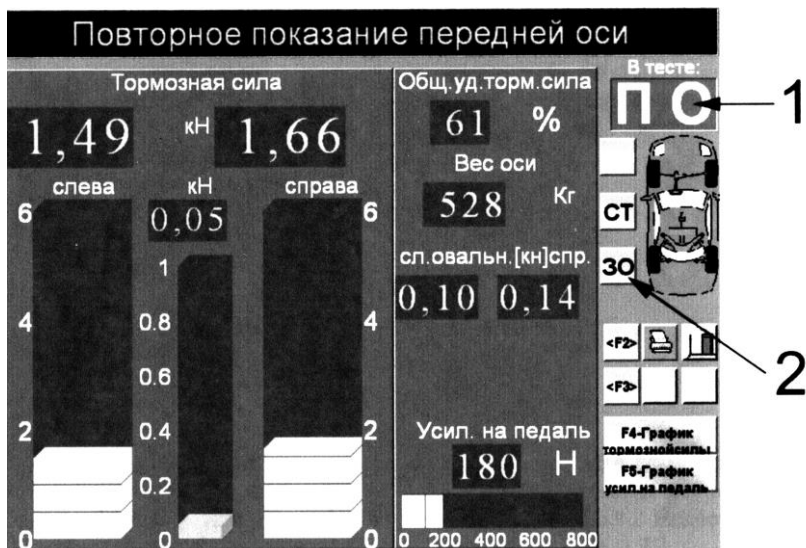
Рис. 7.4. Данные контроля тормозной системы автомобиля: 1 – проверяемая ось; 2 – кнопки переключения между осями транспортного средства; ПО – рабочий тормоз передней оси; СТ – стояночная тормозная система; 30 – рабочий тормоз задней оси.
