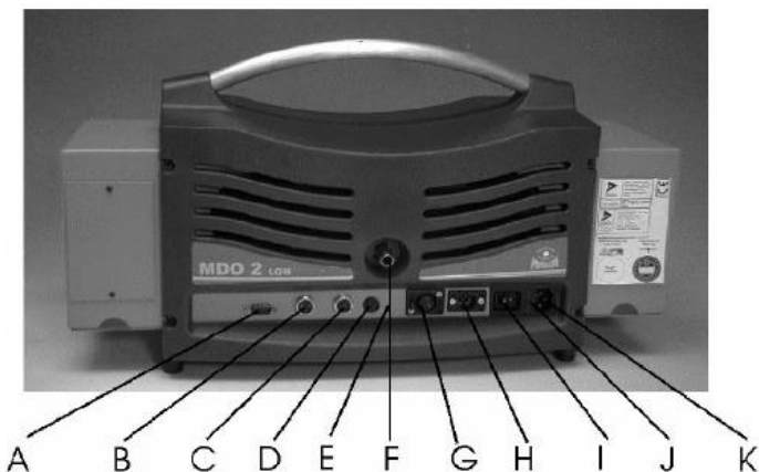
Рис. 4.13. Общий вид дымомера «MDO2 LON»: А – последовательный интерфейс RS 232 для передачи данных, разъем для подключения клавиатуры, совместимой с MF2 (подключение осуществляется через адаптер); В – разъем для подсоединения датчиков частоты вращения (датчика ВМГ, пьезодатчика, датчика W, датчика светового сигнала, Roto-phon); С – разъем для подключения датчика температуры масла; D – плавкий предохранитель; Е – оптическая индикация состояния прибора ВКЛ/ВЫКЛ; F – разъем подключения зонда для отбора пробы; G – разъем для подключения соединительного кабеля базового прибора с ручным пультом; H – разъем для подключения кабеля электропитания от бортового напряжения сети автомобиля 12В/24В; I – выключатель питания; J – плавкий предохранитель; K – разъем для подключения кабеля электропитания 230В.
