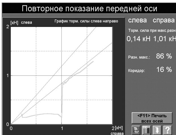
Рис. 7.7. Значения тормозных сил левого и правого колес.
