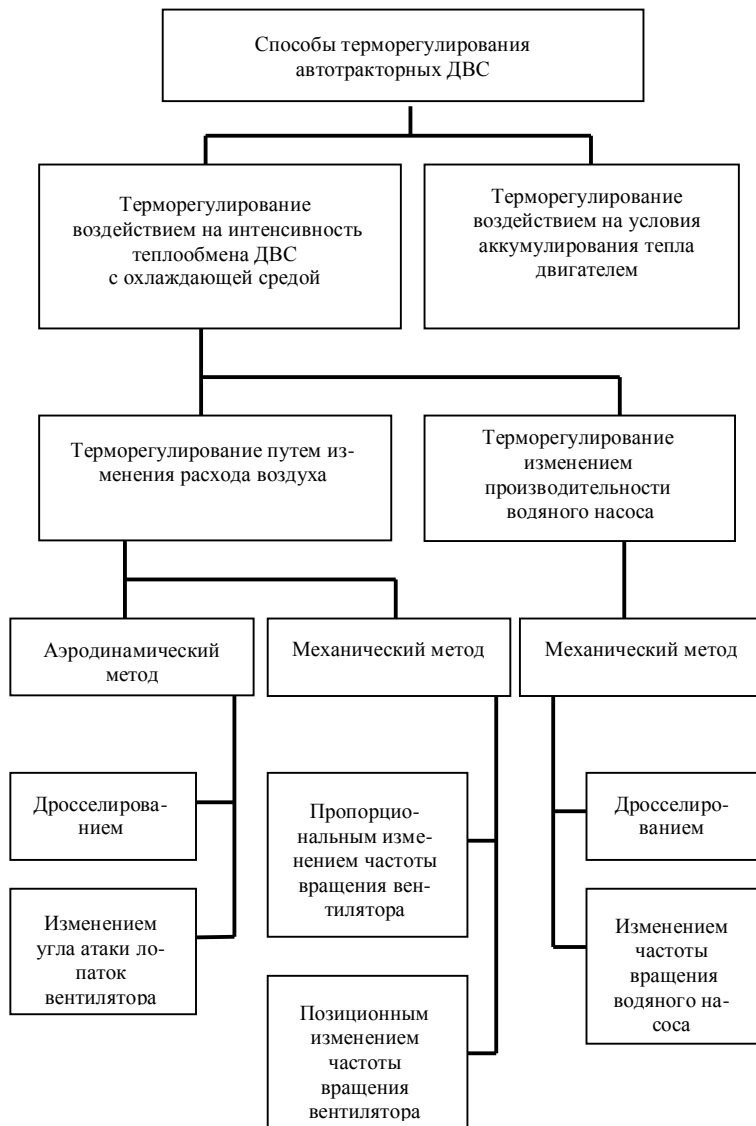
Рис. 3. Способы регулирования температурного режима двигателя.
