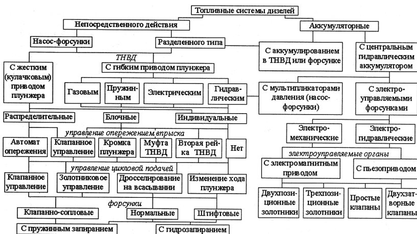
Рис. 4. Классификация топливных систем дизелей.
