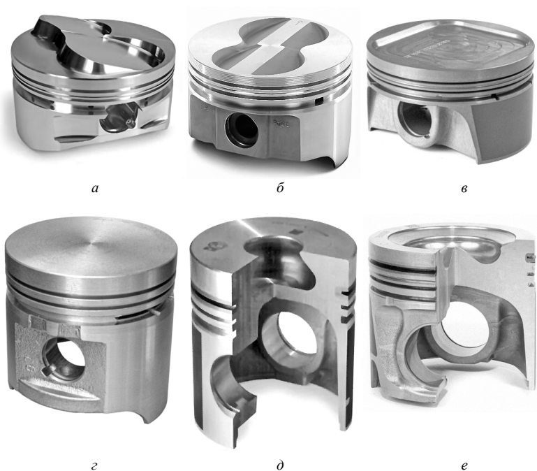
Рис. 6. Форма днища поршней: а – с вытеснителем и выемками клапанов; б – с плоским днищем и выемками для клапанов; в – с углубленным днищем; г – с плоским днищем; д – с трапециевидной камерой сгорания; е – с тороидальной камерой сгорания
