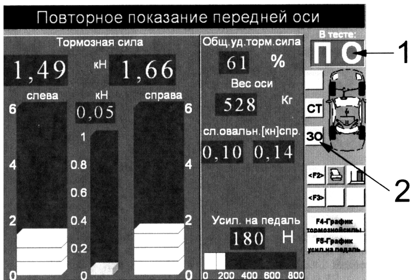
Рис. 2. Данные контроля тормозной системы автомобиля:
