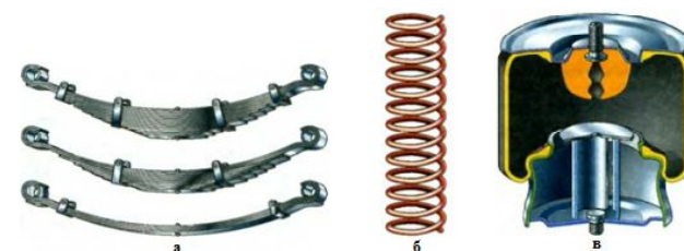
Рис. 5. Виды упругих элементов подвески: а–пластинчатая рессора; б–винтовая пружина; в–пневмобаллон.
