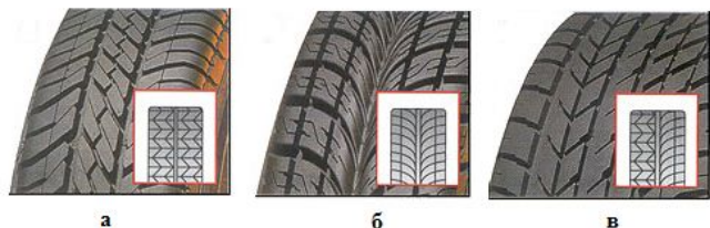
Рис. 15. Дорожные шины с разными типами рисунка: а—ненаправленный; б—направленный; в—асимметричный.
