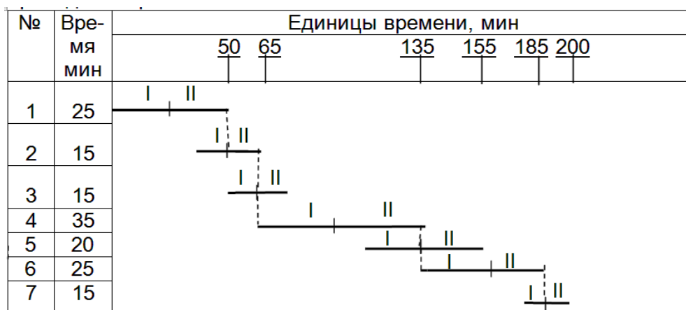
Рисунок 3.5 – График параллельно-последовательного вида движения предметов труда
