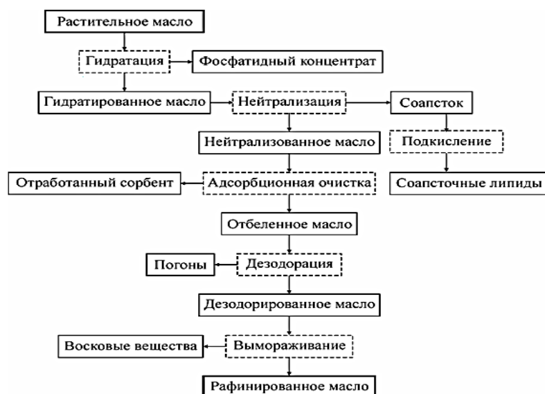
Рисунок – Схема рафинации растительного масла
