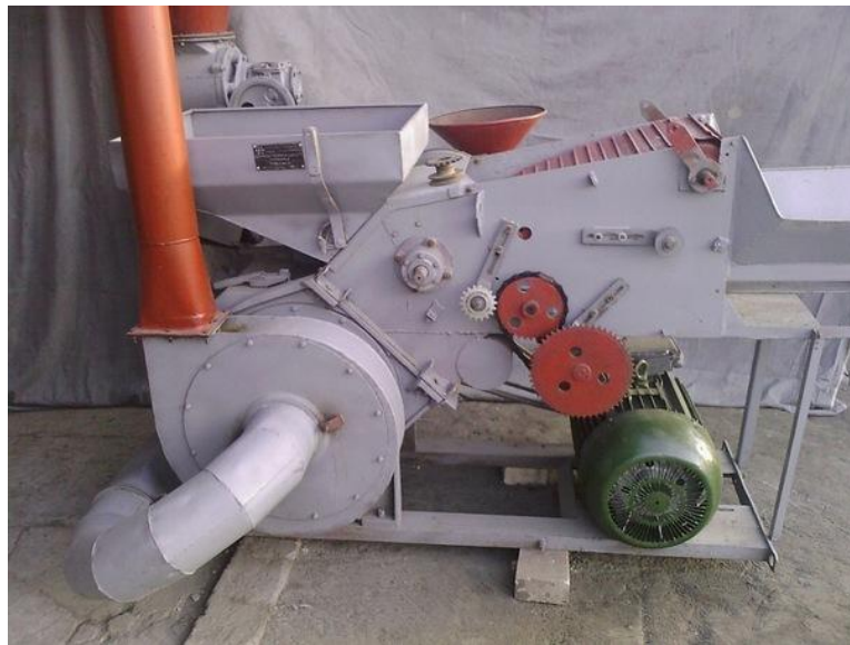
Рис. 7. Универсальная дробилка КДУ-2,0
