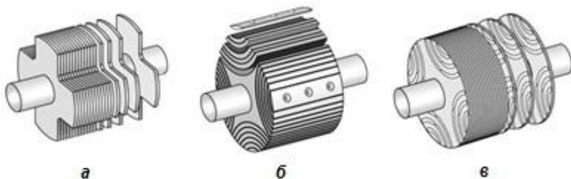
Рис. 8.13. Конструкции роторов синхронного реактивного двигателя: а – с явно выраженными полюсами; б – аксиально-расслоенный; в – поперечно-расслоенный
