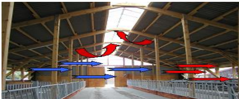
Рис. 27. Схема движения воздушных масс в коровнике
