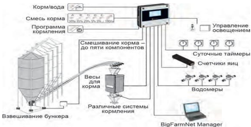
Рис. 2.1. Принципиальная схема управления системой кормораздачи в птичнике
