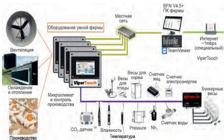
Рис. 1.2. Схема коммутации контроллера в птичнике
