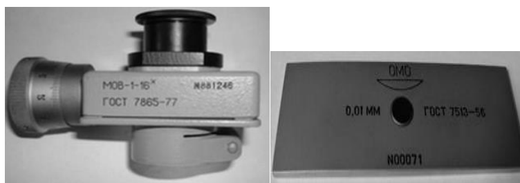
Рис. 4. Микрометр окулярный MOB 1-16 и объект-микрометр
