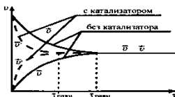
Рис. 6. 2. Влияние катализатора на химическое равновесие.
