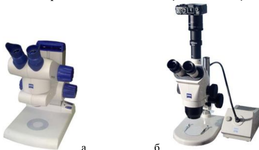
Рис. 6. Лабораторные стереомикроскопы: а – Carl Zeiss Stemi DV 4, б – Carl Zeiss Stemi 2000 C с блоком документирования светооптических исследований
