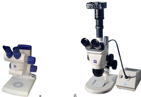
Рис. 6. Лабораторные стереомикроскопы: а – Carl Zeiss Stemi DV 4, б – Carl Zeiss Stemi 2000 C с блоком документирования светооптических исследований
