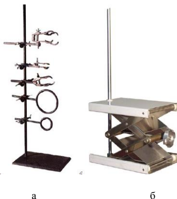
Рис. 1. Штатив с набором зажимов и колец (а) и подъёмный столик (б).
