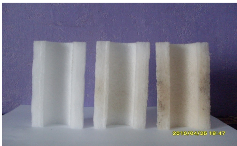
Рис. 7.17. Фильтрующие элементы ФТОЖ (в разрезе) до и после фильтрования молока: слева – до фильтрования; в центре – после фильтрования молока 2-й группы чистоты; справа – после фильтрования молока 3-й группы чистоты
