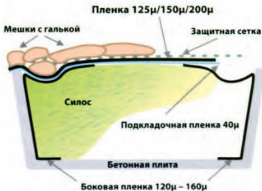
Рис. 2. Укрытие консервируемой массы
