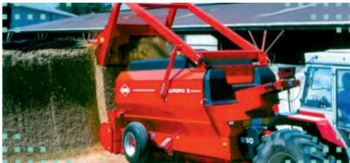
Рис. Прицепной транспортировщик-смеситель-раздатчик кормов с фрезерным погрузчиком
