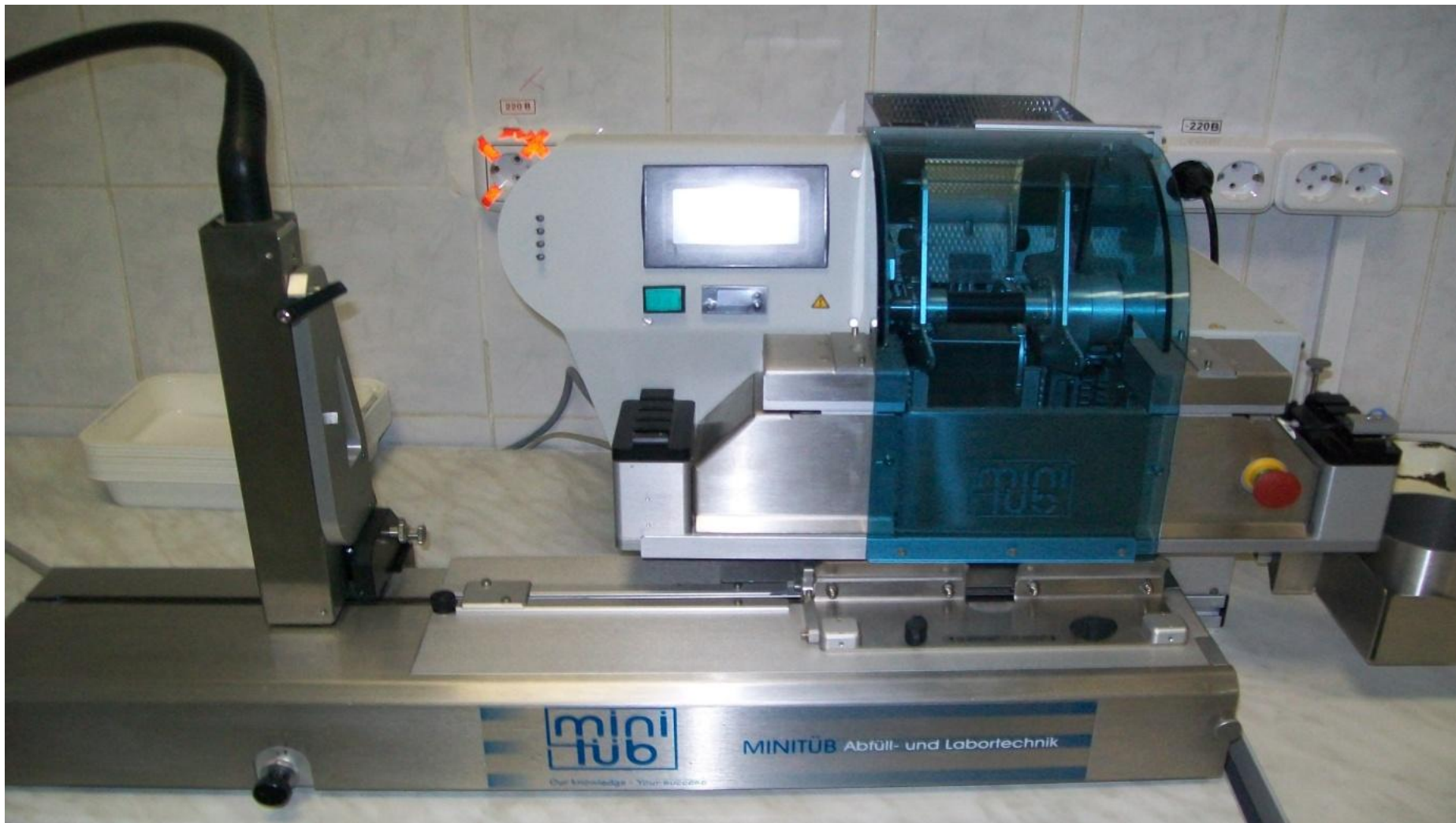
Струйный принтер для маркировки соломки LEIBINGER-JET2 и фасовочно-укупорочное устройство MPP Quattro
