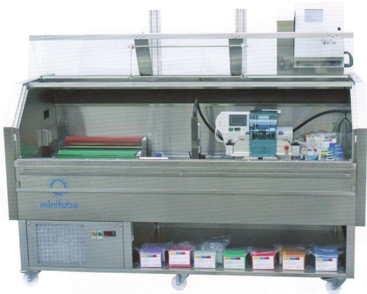
Комбисистема для автоматической расфасовки спермы, размещенная в охлаждающем кабинете
